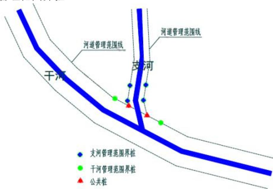
图 4.3-1 干支流交汇无控制性建筑物
