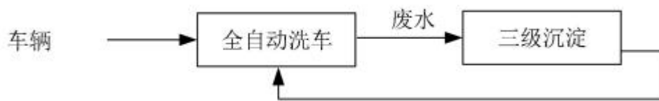
图 2-6 洗车工艺流程图
